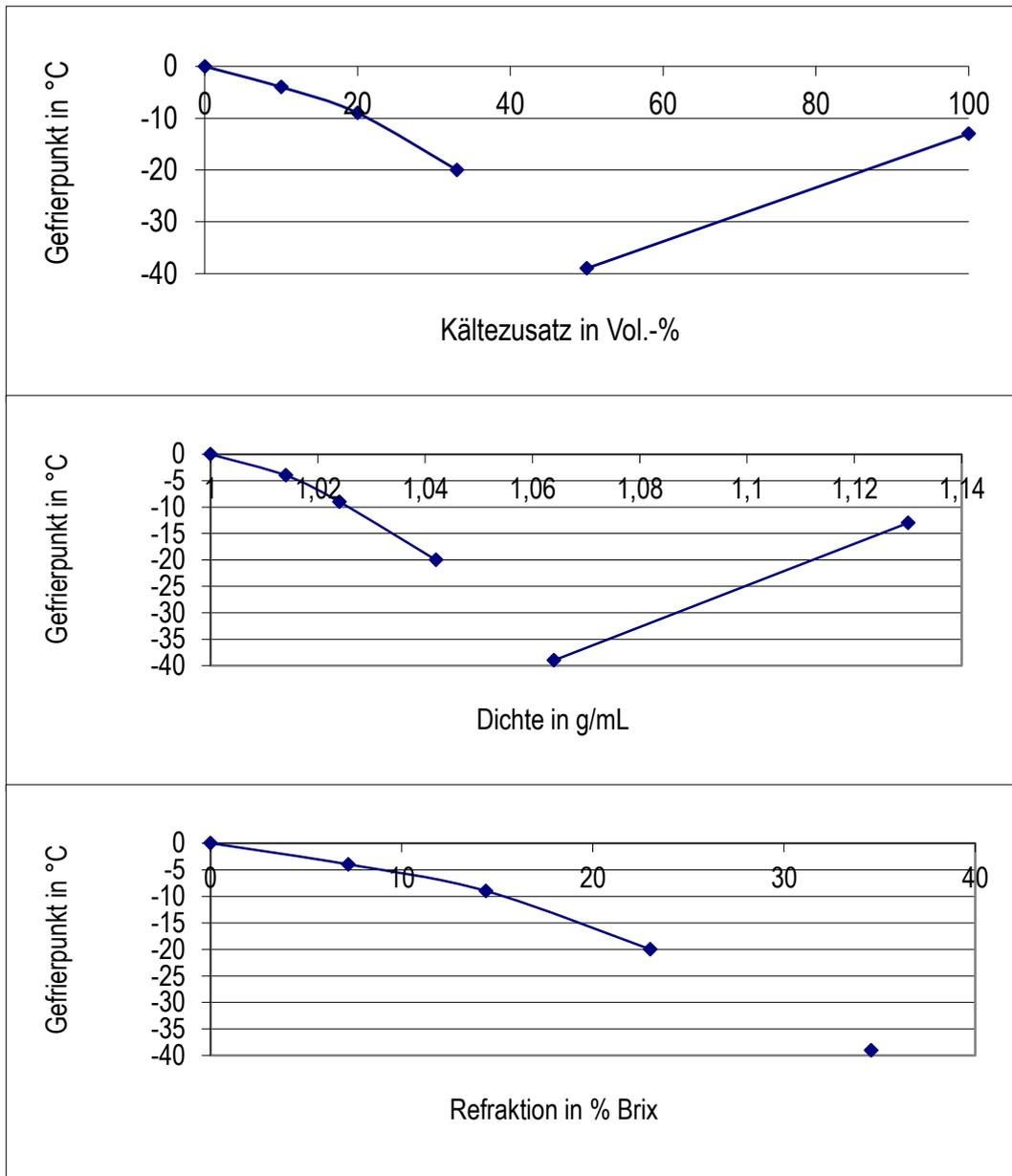
Bitte beachten Sie, dass die Messwerte durch weitere Stoffe im Wasser verfälscht werden können. So täuschen z.B. Kreislaufzusätze, Biozide oder Verschmutzungen geringfügig höhere Dichten oder Refraktometerwerte vor. Eine sichere Bestimmung des Frostschutzes vor Ort ist nur in frischem Wasser möglich.
